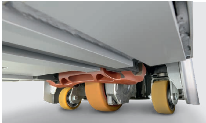
Plynulý pohyb na rampách: stabilní trakce díky hydraulicky odpruženým opěrným kolům
