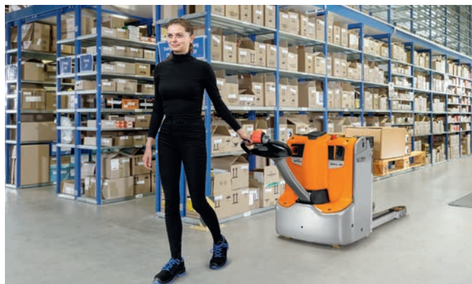
Vždy bezpečný pohyb: díky řídicí oji OptiSpeed plynule regulujete rychlost jízdy podle úhlu oje
