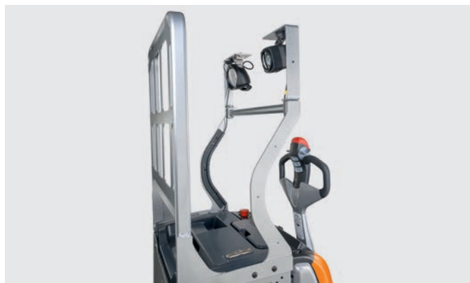
Maximální bezpečnost při nakládání a vykládání nákladních vozidel díky STILL Bezpečnost Light a pracovnímu osvětlení u modelu EXH 25-30
