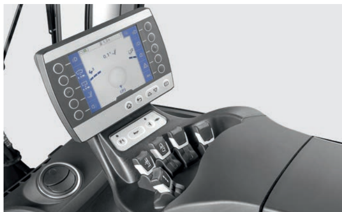
Bezpečné a intuitivní ovládání se zobrazovacím a ovládacím modulem STILL Easy Control
