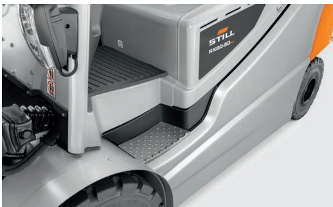
Velká a protiskluzná stupačka umožňuje snadné nastupování a tím přináší vysokou bezpečnost
