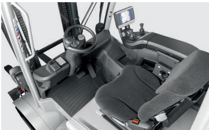
Prostorné místo pro řidiče přispívá ke snížení únavy při práci
