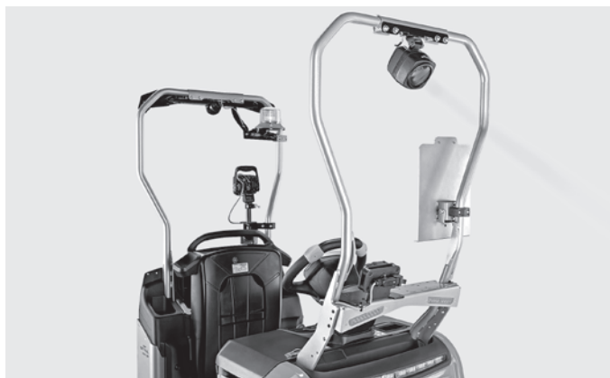
Maximální viditelnost vozíku v okolí a tím i bezpečnost obsluhy dosahovaná prostřednictvím volitelných systémů Safety Light a Safety Light 4Plus 2
