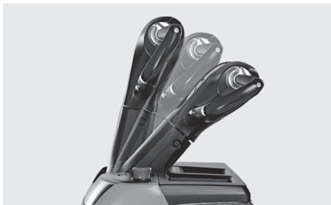
Výškově přestavitelné řízení přizpůsobitelné rozdílným tělesným výškám řidiče 1
