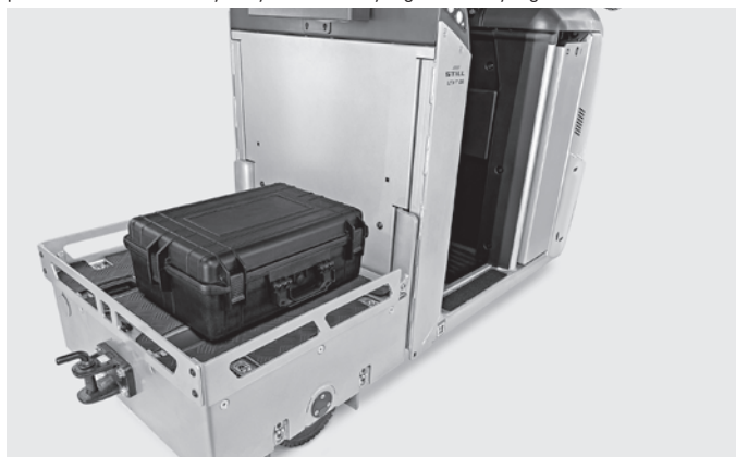
Ložná plocha s uzavazovacími oky a nosností až 600 kg 3
