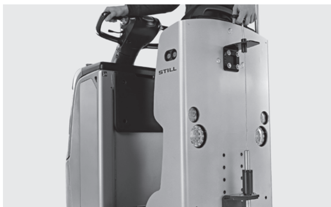
Rychlé odjišťování spojky z místa řidiče 1
