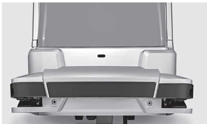
360° ochrana osob díky integrovaným bezpečnostním laserovým skenerům v LTX 50 iGo systems
