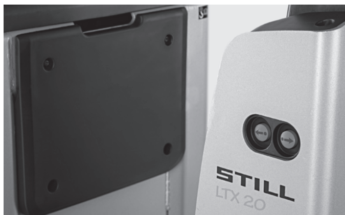
Funkce ovládání kráčejí obsluhou umožňující efektivní provoz při vychystávání 1
