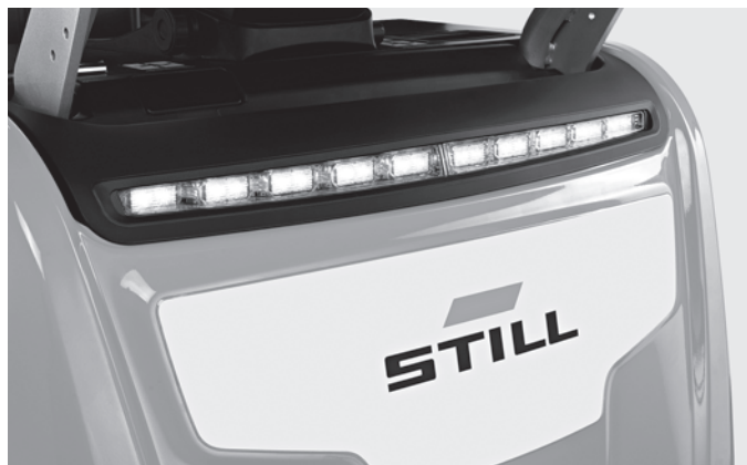
Volitelné LED denní osvětlení zajišťující maximální viditelnost v okolí a tím i vyšší úroveň bezpečnosti práce 2
