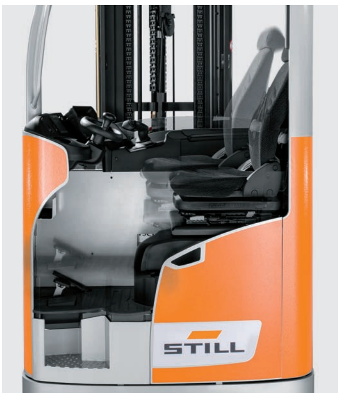
Výškově nastavitelné sedadlo a stupátko pro zajištění ergonomicky optimální polohy řidiče
