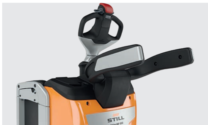
Bezpečné a ergonomické umístění plošiny pro obsluhu s volitelnými sklápěcími bočnicemi
