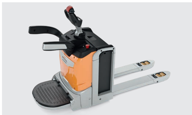
Mechanicky odpružená plošina poskytuje obsluze pohodlí a současně zvyšuje pohodlí při ovládání
