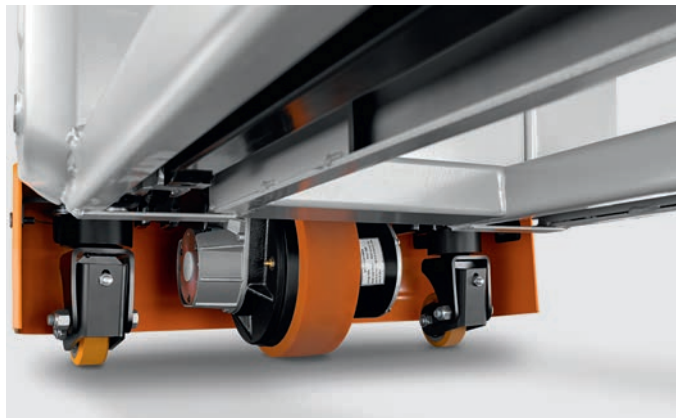
Sériově dodávaná opěrná kola zajišťují lepší boční stabilitu
