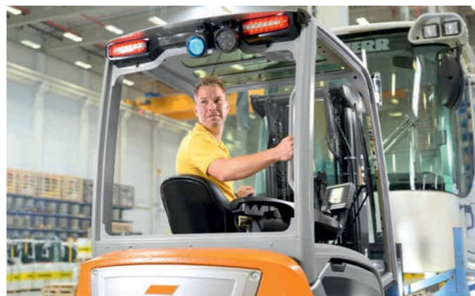
Otočné sedadlo s na přání dodávaným ovládním houkačky umožňující bezpečnou jízdu vzad
